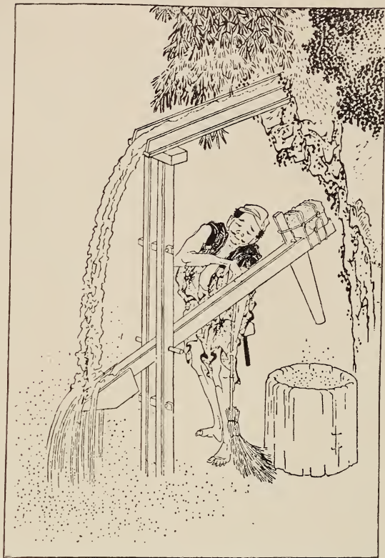
Abb. 18. Reisstampfer, der den Hebel durch Wasserdruck in Betrieb setzt.
